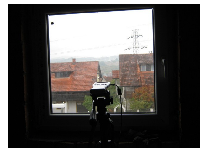
Мерна тачка Т1 ОШ „Милован Глишић“ у изградњи 2. спрат, поред прозора 12 m од ДВ 35 kV
