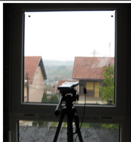
Мерна тачка Т2 ОШ „Милован Глишић“ у изградњи 2. спрат, поред прозора 5 m од ДВ 35 kV
