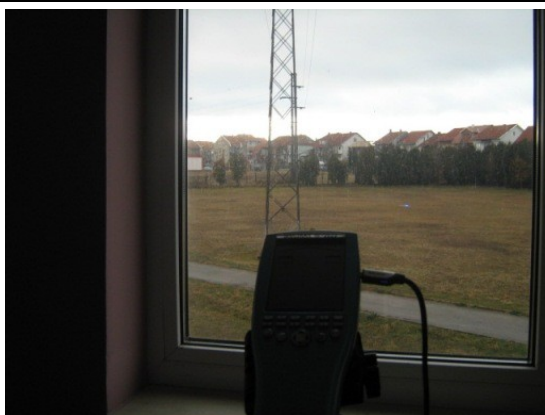
Мерна тачка Т5 Специјална школа „Бубањ“ Бубањских хероја 3 кабинет за физику, 1. спрат, испод 35 kV ДВ
