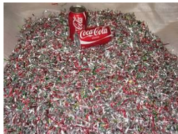
Слика 5.9 Уситњавање алуминијумских лименки
