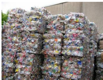
Слика 5.6 Пример балиране ПЕТ амбалаже
