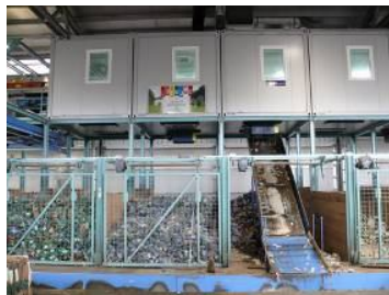
Слика 5.3 Изглед постројења за сепарацију отпада
