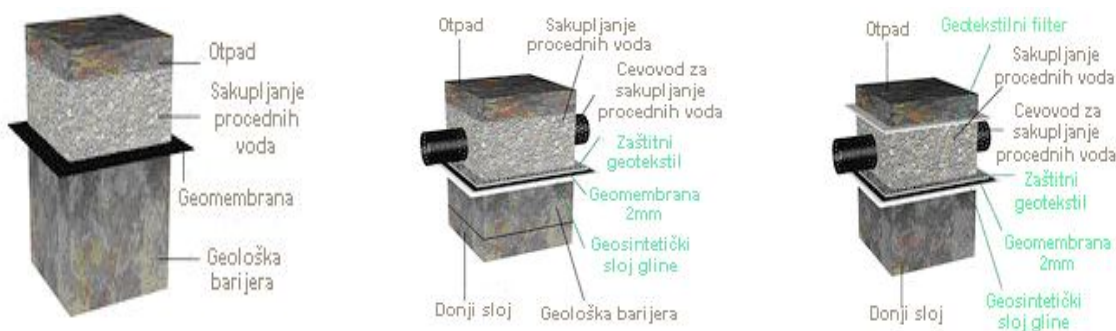
Слика 6.10 Приказ доњих слојева депоније
