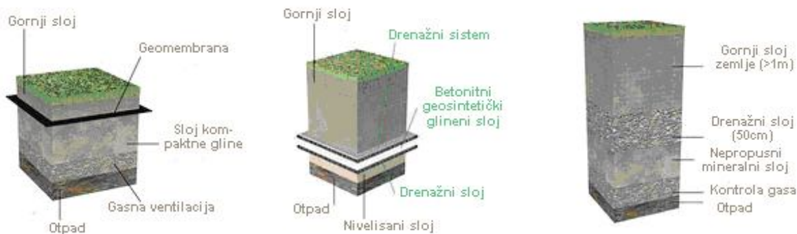
Слика 6.6 Приказ горњих покривних слојева депоније
