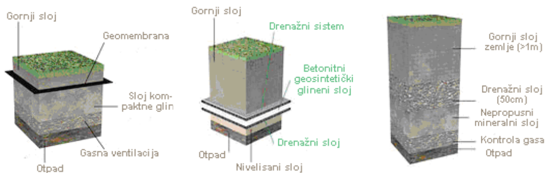
Слика 5.9. Приказ горњих покривних слојева депоније
