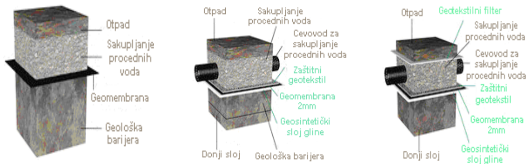
Слика 5.13. Приказ доњих слојева депоније
