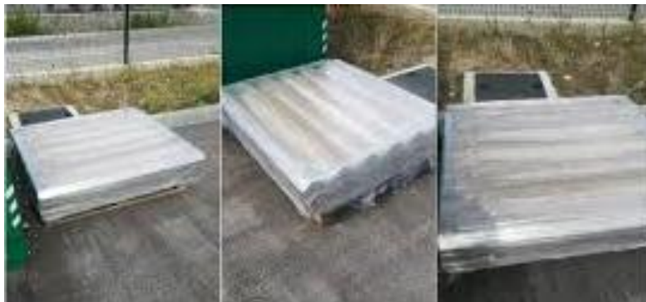
Слика бр.26: Правилан начин складиштења азбестног отпада на рециклажном дворишту
