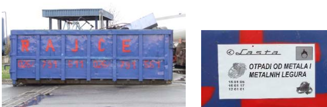
Слика 34 – Контејнер за сакупљање металног отпада – "Ласта" и начин обележавања места за сакупљање
