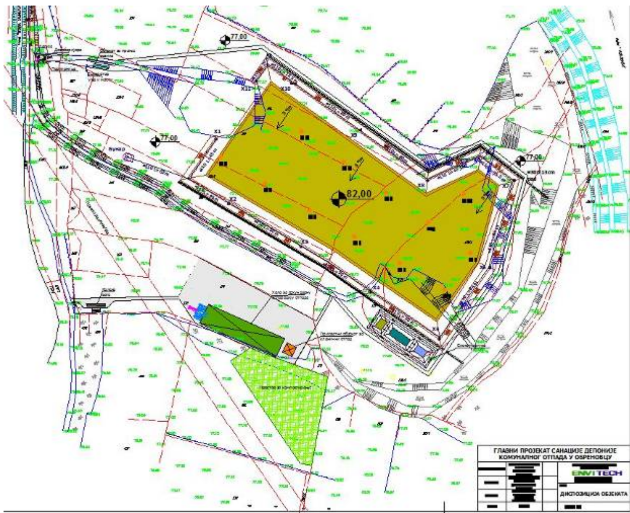
Слика 21 - Техничко решење санације комуналне депоније "Гребача" са диспозицијом пратећих објеката
