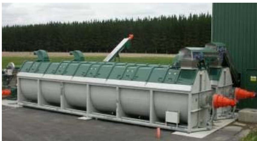
Слика 58 - Изглед хоризонталног реактора
