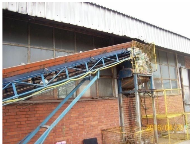
Слике 9 и 10: Улаз пластике у процес балирања
