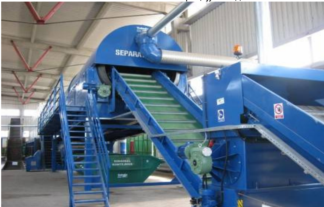
Слика 10.8. Унутрашњост хале за сепарацију отпада "Техник"
