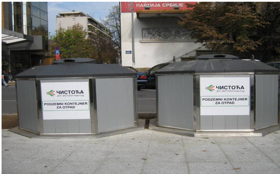
Слика 9.6.2. Пример савременог система за прикупљање комуналног отпада у подземним контејнерима у Новом Саду
